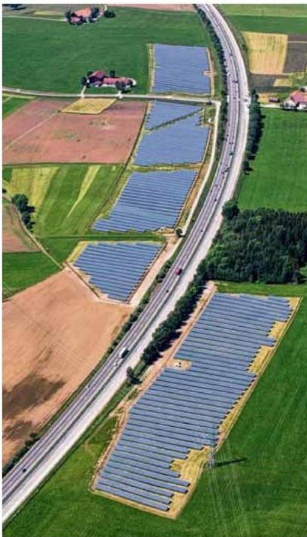
Der Solarpark Haldenwang: Insgesamt rund zehn Hektar groß, bestückt mit knapp 25000 Modulen beiderseits der Autobahn A7.
